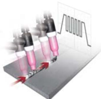
Permet de focaliser l'action et d'obtenir une meilleure stabilité de l'arc électrique.
